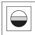
Maschera ad innesto per la copertura della zona di rilevamento verticale in caso di montaggio UP/AP per la dissolvenza di fonti di disturbo al di sotto dell'apparecchio (per es. animali di piccola taglia, ecc.)
